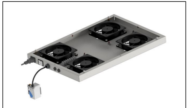
87183428: ventilátoros fiók termosztáttal, közvetlenül a tetőlemez alsó felére csavarozható, nem foglal el helyet a szekrény belső méretéből, 4 és 6 ventilátoros verzióban is rendelhető.
