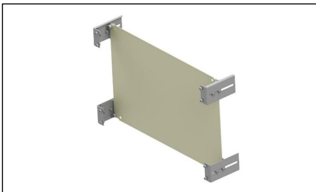
27152564: 19" rackbe szerelhető egyedi méretű szerelőlap felfogató készlet, (a szerelőlap nem tartozéka külön rendelendő, 37156868: 350mm magas, 37156869: 550mm magas cikkszám, valamint egyedi méretben is elérhető.)
